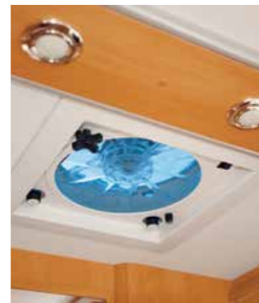
MKM-Lüfter in der Küche
