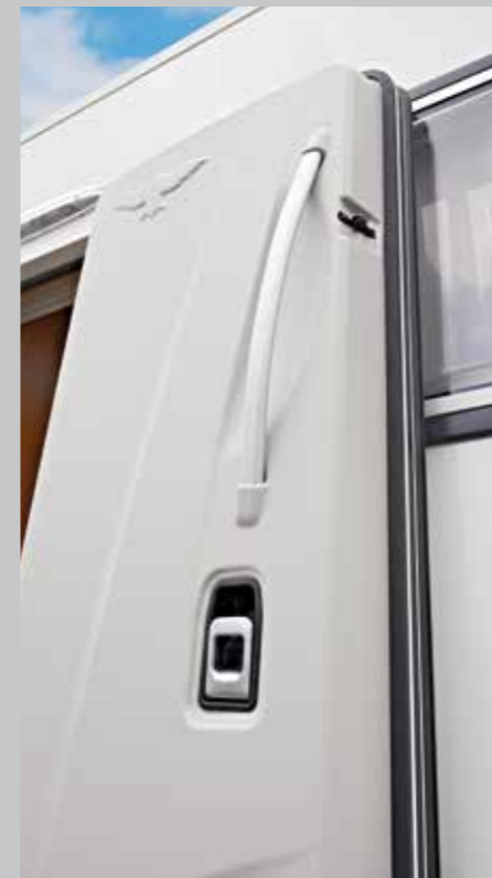
Eingangstüre mit Sicherheitsschloss und Funkfernbedienung
