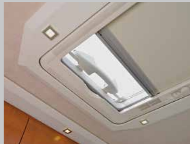
HeKi mit Deckenbaldachin und Beleuchtung
