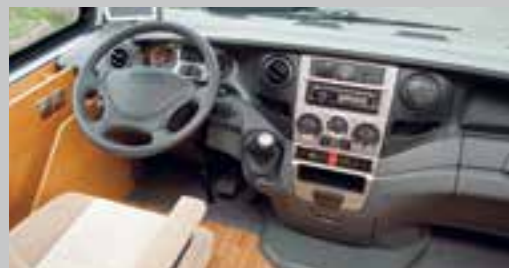
Durchgehender Boden und isolierter Frontbereich unter dem Original Iveco Armaturenbrett
